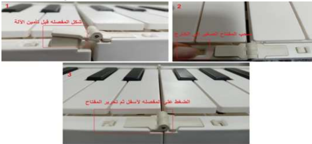
شكل رقم (٦) يوضح خطوات فرد الآلة بشكل صحيح.
