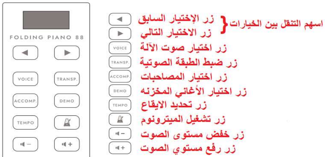
شكل رقم (٤) يوضح وظائف ازرار لوحة التحكم الأمامية للآلة.
